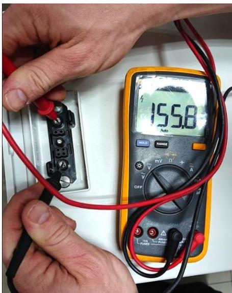
Si el voltaje medido se desvía significativamente del valor nominal, verifique el voltaje de cada módulo, como se muestra en la sección siguiente.
